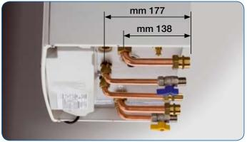
La distanza tra gli attacchi e la parete retrostante è di 138 mm per il riscaldamento e di 177 mm per sanitario e gas, per facilitare le operazioni di installazione.
